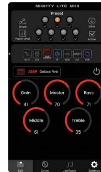
Mit der MightyAmp™ App und der Mighty Editor™ Editor-Software können Sie alle Signalblöcke und Parameter beliebig einstellen. Der MIGHTY LITE BT MKII enthält die Signalblöcke GATE, EFX, AMP, IR, MOD, DLY und RVB. Neben den 36 ab Werk vorinstallierten IRs stehen 18 leere Slots zum Laden von Drittanbieter-IRs zur Verfügung. Machen Sie sich keine Sorgen um die Samplingrate: Die Editor-Software Mighty Editor™ kann das WAV-Format (IR) automatisch konvertieren.
